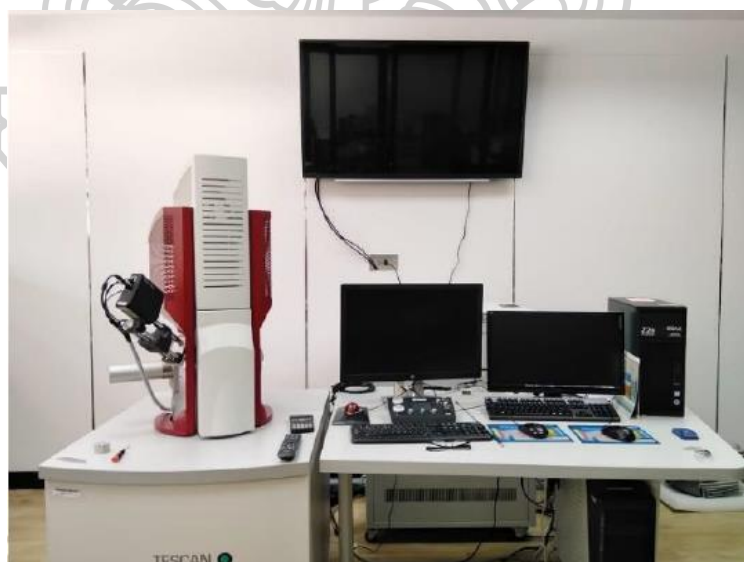
รูปที่ 3.5 เครื่อง Field Emission Scanning Electron Microscope, FESEM รุ่น MIRA3 จากบริษัท TESCAN
