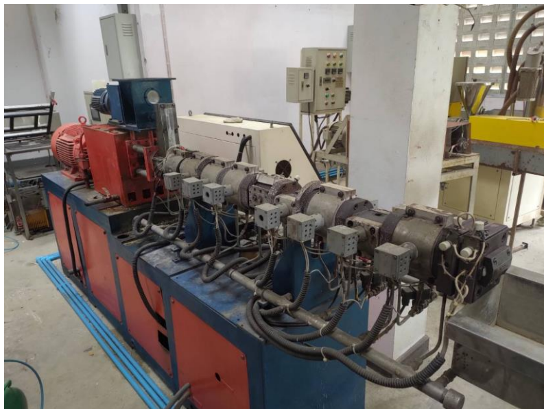
รูปที่ 3.7 เครื่องอัดรีดแบบสกรูคู่ twin-screw extrusion รุ่น HRJ-25 จากบริษัท Enmach Co., Ltd
