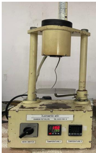
รูปที่ 3.4 เครื่อง Melt Flow Indexer รุ่น Plastometer: MFR1 จากบริษัทเจริญทัศน์
