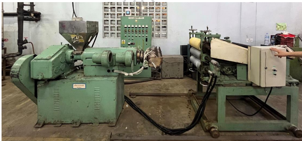
รูปที่ 3.12 เครื่องอัดรีดแผ่นฟิล์ม (Cast film extruder) จากบริษัท Modern Machinery Co., Inc. (ได้รับความอนุเคราะห์จากบริษัท ดี.เอช.เอ. สยามวาลา จำกัด)
