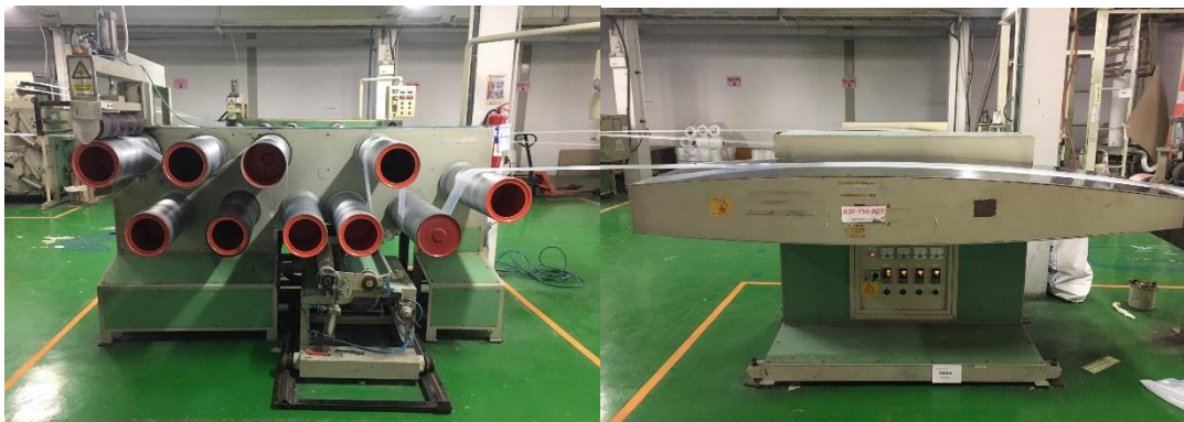
รูปที่ 3.13 เครื่องรีด-ยึดฟิล์ม Heat film [B3F-YM-A07] (ขวา) และชุดลูกกลิ้งดึงเส้นใย roll cutting [B3F-YM-A08] (ซ้าย) (ได้รับความอนุเคราะห์จากบริษัท แอ็พพลาย ดีบี จำกัด)
