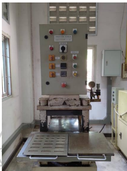
รูปที่ 3.3 เครื่อง Compression molding รุ่น PR10-W300L350 จากบริษัทเจริญทัศน์
