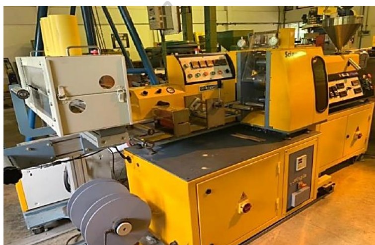
รูปที่ 3.8 เครื่องอัดรีดแผ่นฟิล์ม (Cast film extruder) รุ่น LBE20-30/P จากบริษัท Labtech Engineering ประเทศไทย
