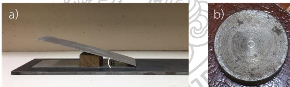
รูปที่ 3.11 อุปกรณ์วัดค่าสัมประสิทธิ์แรงเสียดทานอย่างง่าย a) ฐานปรับมุม b) ลูกตุ้มเพิ่มน้ำหนักฟิล์ม
