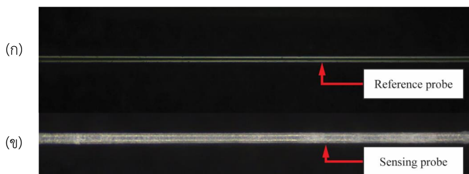
รูปที่ 4.8 ภาพเปรียบเทียบสายใยแก้วนำแสงที่ผ่านกระบวนการพอกสารประกอบทางเคมี;
