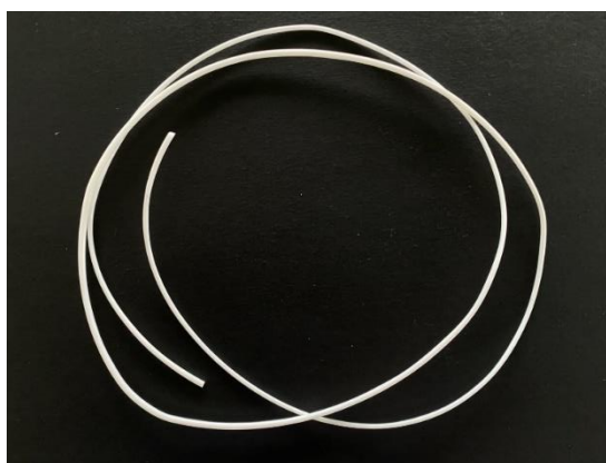
ภาพที่ 4.1 ตัวอย่างเส้นฟิลาเมนต์ของพอลิเมอร์ผสม PLA/PBAT
