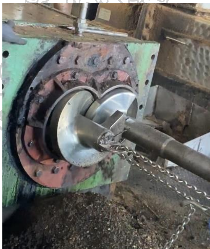
ภาพที่ 19 ตัวอย่างการตรวจเช็คและเปลี่ยนชิ้นส่วนอุปกรณ์เครื่องจักร
