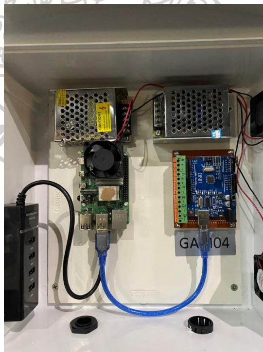
ภาพที่ 55 ภายในตัวควบคุมที่นำไปควบคุมและเก็บข้อมูลจากเซนเซอร์
