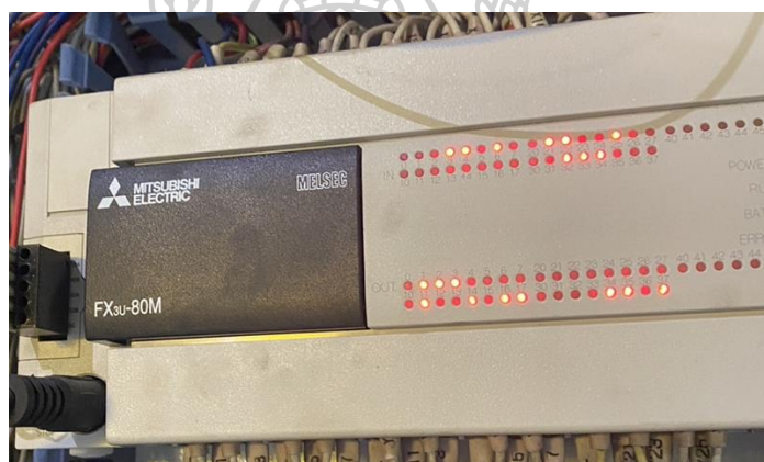
ภาพที่ 20 Mitsubishi Electric รุ่น FX3u-80M ที่ใช้กับเครื่องเป่าถังขนาด 10 ลิตร
