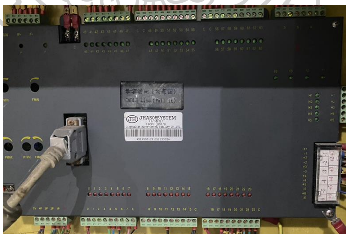
ภาพที่ 23 JHA รุ่น micro control JHA 05 SYSTEM ใช้กับเครื่องฉีดถึงปากกว้างขนาด 20 ลิตร
