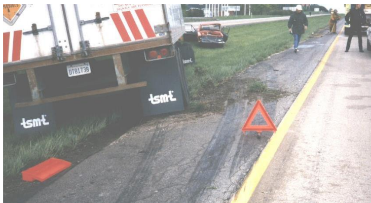
ภาพที่ 2 ลักษณะของรอยแฉลบ (Yaw Marks)
