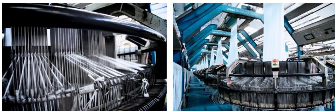
ภาพที่ 7 กระบวนการทอแถบพลาสติก (ซ้าย) และกระบวนการขึ้นรูปถุง (ขวา)
