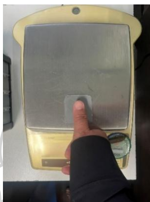
รูปภาพที่ 24 ภาพแสดงอาสาสมัครกดนิ้วลงบนแผ่นเหล็กด้วยน้ำหนักประมาณ 1 กิโลกรัม และค้างไว้ประมาณ 5 วินาที
