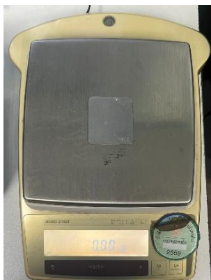
รูปภาพที่ 29 ภาพแสดงเครื่องชั่งน้ำหนัก 2 ตำแหน่ง และแผ่นเหล็กขนาดกว้างxยาว ขนาดประมาณ 5x5 เซนติเมตร
