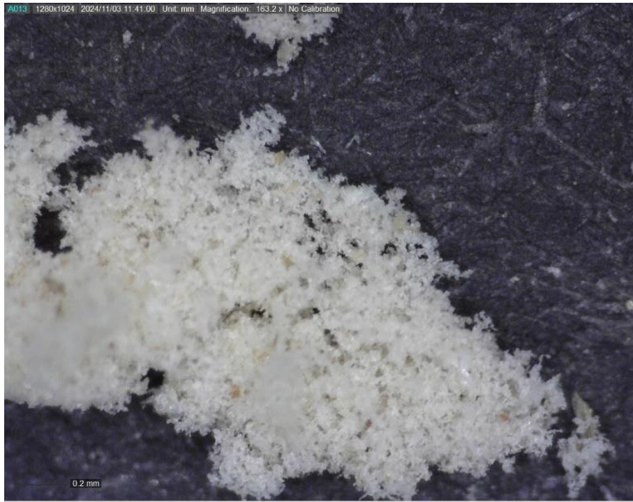
ภาพที่ 26 ผงซีลี้อยไม้แบบละเอียดจากกล้องจุลทรรศน์ดิจิทัล กำลังขยายที่ 0.2 mm
