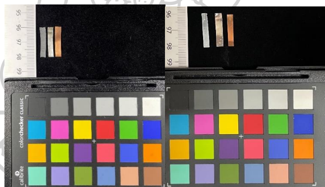
รูปที่ 3.14 การถ่ายรูปแผ่นโลหะ (A) แผ่นโลหะควบคุม (B) แผ่นโลหะที่มีการบรรจุตัวอย่างกำมะขาม
