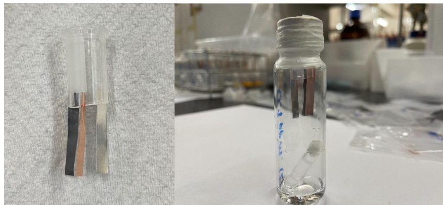
รูปที่ 3.11 การเตรียมแผ่นโลหะใส่หลอดทดลอง
