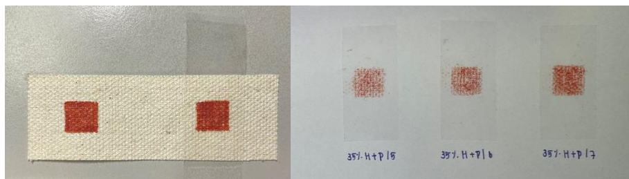
รูปที่ 3.10 การทดสอบการยึดเกาะของกาวผสมผงสี
