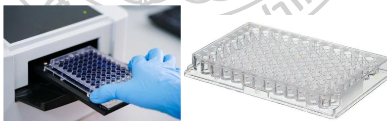
รูปที่ 3.2 Microplate reader และ 96 well plate
