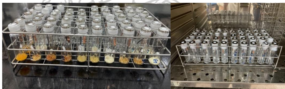
รูปที่ 3.12 การนำหลอดทดลองเข้าตู้อบควบคุมอุณหภูมิ 60 องศาเซลเซียส ตลอด 24 ชั่วโมง เป็นระยะเวลา 28 วัน
