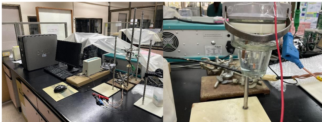
รูปที่ 3.20 การทดสอบการนำไฟฟ้าของแผ่นโลหะ
