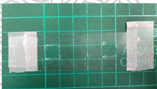
รูปที่ 3.21 การเตรียมชิ้นงานผ้าใบจำลองสำหรับการทากาว
