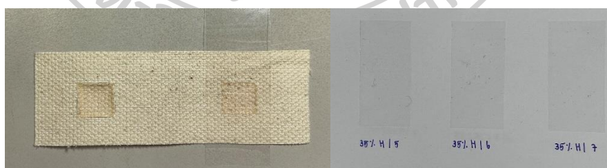
รูปที่ 3.9 การทดสอบการยึดเกาะของกาว
