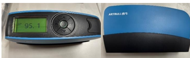
รูปที่ 3.19 เครื่องวัดความเงา (Gloss meter)
