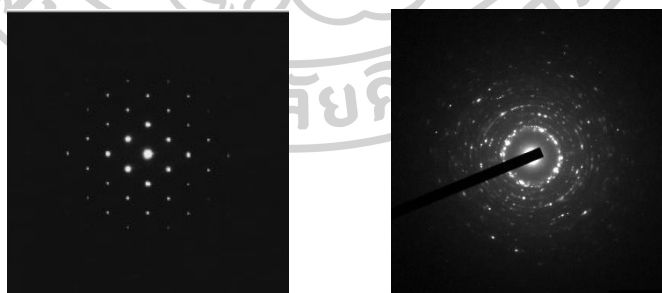
ภาพที่ 6 รูปแบบการเลี้ยวเบนของวัสดุแบบผลึกเดี่ยว (ซ้าย) และพหุผลึก (ขวา)
