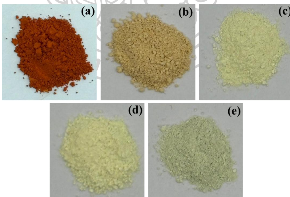
ภาพที่ 29 ลักษณะทางกายภาพที่มองเห็นได้ด้วยตาของ (a) BiOI (b) BA-70:30 (c) BA-50:50 (d) BA-30:70 และ (e) AgI
