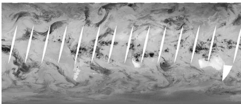
รูปที่ 20 ลักษณะภาพถ่ายดาวเทียมของค่าอุณหภูมิการส่องสว่าง ช่องสัญญาณที่ 31
