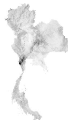
รูปที่ 20 ลักษณะภาพถ่ายดาวเทียมของค่าอุณหภูมิการส่องสว่าง ช่องสัญญาณที่ 31
