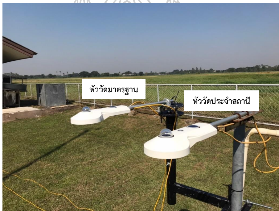
รูปที่ 13 ตัวอย่างการติดตั้งเครื่องวัดมาตรฐานเพื่อทำการสอบเทียบ
