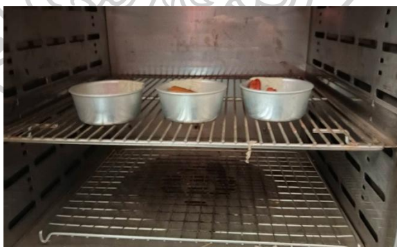
รูปที่ 52 นำมวลตัวอย่างอบแห้ง 103°C เป็นเวลา 24 ชั่วโมง
