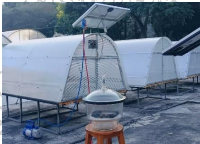
รูปที่ 27 เครื่องอบแห้งพลังงานแสงอาทิตย์แบบพาราโบลาและหม้อดูดความชื้นความดันต่ำ
