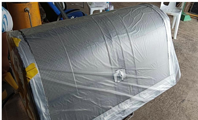
รูปที่ 34 ทดสอบการลดความดันอากาศภายในโคมอบแห้ง
