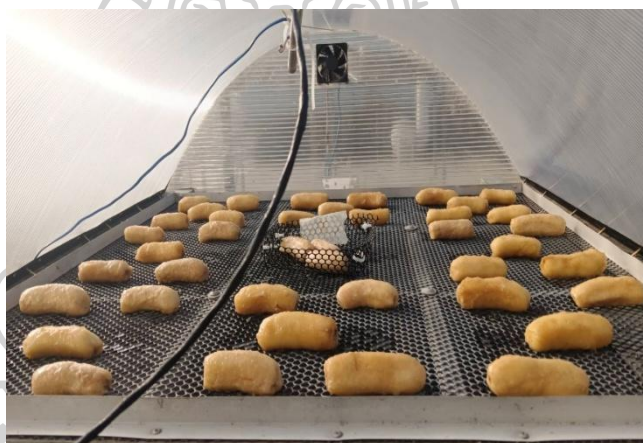
รูปที่ 43 การอบแห้งกล้วยสำหรับพาราโบลาโดมที่ความดันบรรยากาศ
