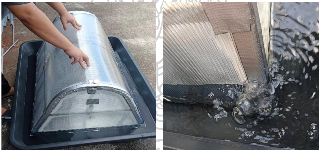
รูปที่ 33 ทดสอบการรั่วซึมของอากาศของโคมอบแห้ง
