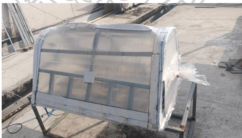
รูปที่ 49 การอบแห้งกล้วยด้วยเครื่องอบแห้งพลังงานแสงอาทิตย์ความดันต่ำ
