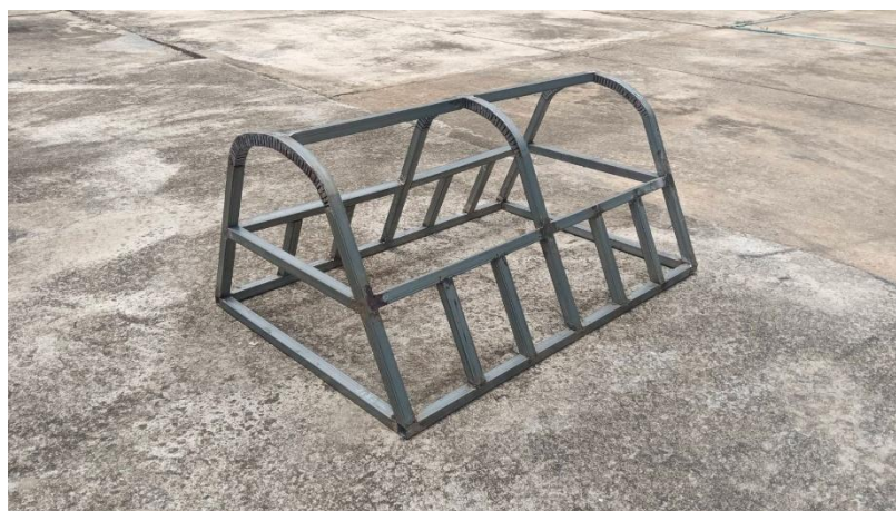
รูปที่ 31 โครงเครื่องอบแห้งพลังงานแสงอาทิตย์แบบพาราโบลาโดมสำหรับอบแห้งความดันต่ำ
