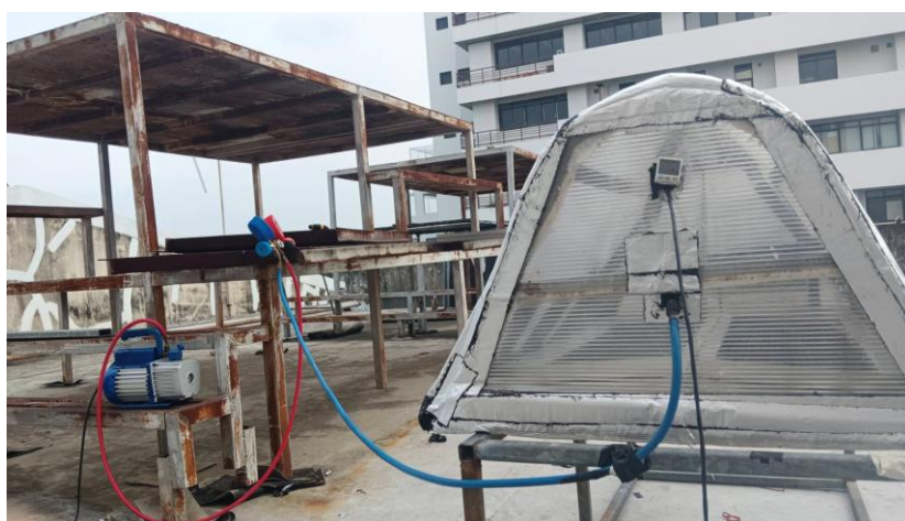
รูปที่ 40 ตำแหน่งเซนเซอร์วัดความดันอากาศภายในห้องอบแห้งและสายต่อปั๊มดูดอากาศในห้องอบแห้ง
