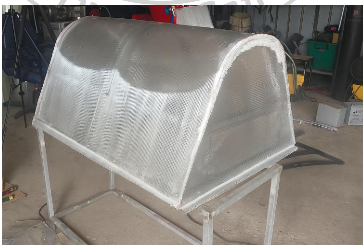
รูปที่ 32 เครื่องอบแห้งพาราโบลาโดมสำหรับอบแห้งที่ความดันต่ำ
