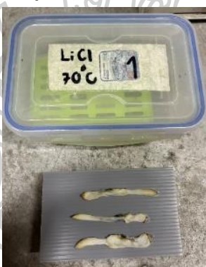
รูปที่ 8 กล่องพลาสติกบรรจุสารละลายเกลือ 50°C 60°C และ 70°C อิมตัวและมวลตัวอย่างของหอยหลอด 5-6 g
