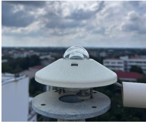
รูปที่ 16 เครื่องวัดความเข้มรังสีอาทิตย์แบบเทอร์โมไฟลีย์หือ Kipp and Zonen รุ่น CMP21
