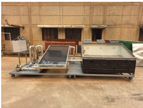
รูปที่ 6 เครื่องอบแห้งแบบผสม (www.teriin.org)
