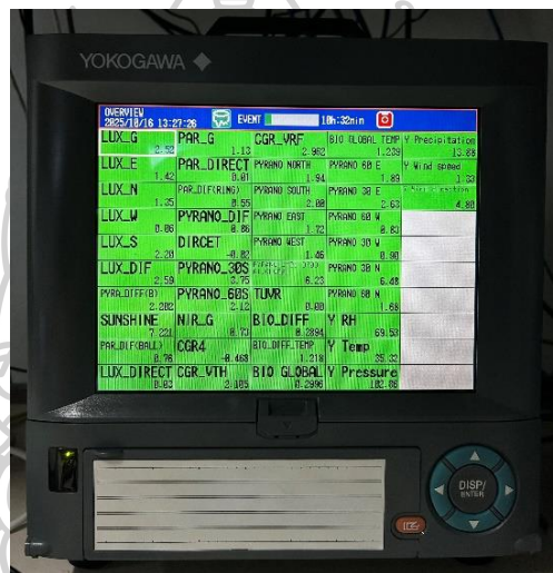
รูปที่ 17 เครื่องบันทึกข้อมูลหือ Yokogawa รุ่น DX2000
