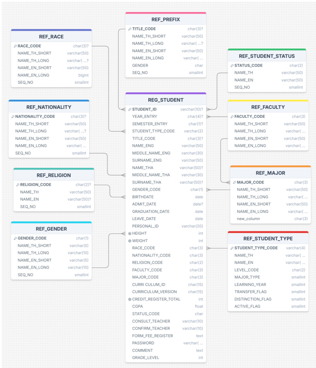
ภาพที่ 20 การออกแบบฐานข้อมูลใหม่ (ER Diagram) แสดงความสัมพันธ์ระหว่างเอนทิตีหลัก ได้แก่ นักศึกษา หลักสูตร รายวิชา การลงทะเบียนเรียน และตารางอ้างอิง (ดูทั้งหมดได้ที่ภาคผนวก)
