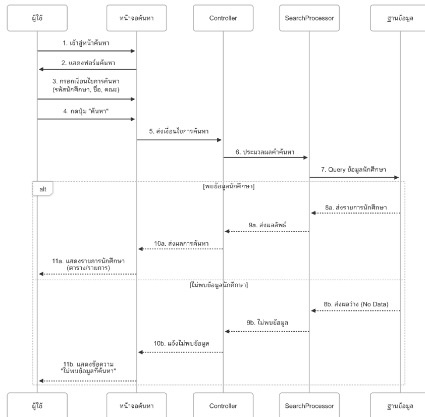
ภาพที่ 18 ลำดับขั้นตอนการทำงานของระบบต้นแบบ แสดง Sequence Diagram สำหรับกรณีการค้นหาข้อมูลนักศึกษา
