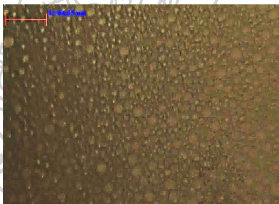
ภาพที่ 4.2.2 สารละลายอิมัลชันที่มีการเติม internal phase 80 เปอร์เซ็นต์โดยปริมาตรทดสอบด้วยเครื่อง optical microscope
