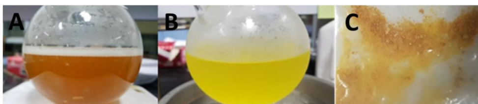
ภาพที่ 4.1.2 A ) สารละลายไคโตซาน B ) สารละลายไคโตซานหลังการตัดสายโซ่ด้วยไฮโดรเจนเปอร์ออกไซด์และ C ) สารที่ได้หลังจากทำการตกตะกอนด้วยเอทานอล
