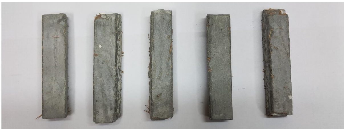
รูปที่ 89 ชิ้นงานสูตร M34(M33F1)M34 ก่อนทำการทดสอบ Limited oxygen index (LOI)
