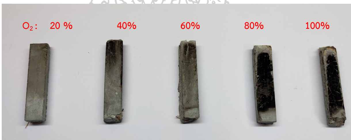
รูปที่ 90 ชิ้นงานสูตร M34(M33F1)M34 หลังทำการทดสอบ Limited oxygen index (LOI) ที่ %O 2 เท่ากับ 20 -100 %
