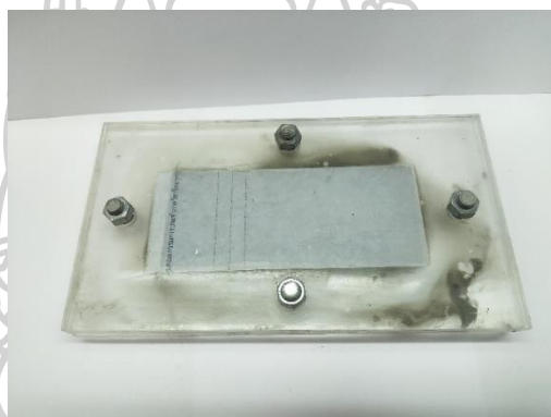
รูปที่ 31 ทำการถอดชิ้นงานตัวอย่างออกจากแม่พิมพ์จะได้ชิ้นงานที่มีขนาด 5 \times 12 \times 0.5 \text{ cm}^3
