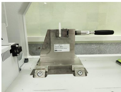
รูปที่ 44 การวางชิ้นงานทดสอบแรงกระแทก
