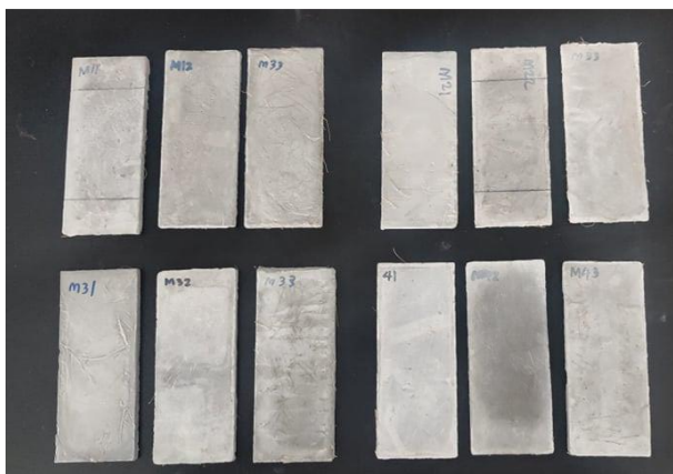
รูปที่ 33 ตัวอย่างชิ้นงานที่ผ่านการขึ้นรูปและบ่มในน้ำเป็นเวลา 28 วันสำหรับการศึกษาผลของขนาด และปริมาณของเส้นใยมะพร้าวที่ส่งผลต่อสมบัติซีเมนต์คอมโพสิต
