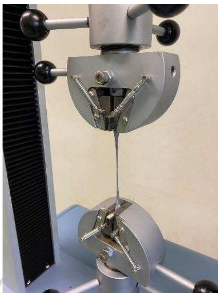
รูปที่ 4.2 การทดสอบวัสดุยืดหยุ่นโดยอาศัยเครื่อง Universal Tensile Tester
