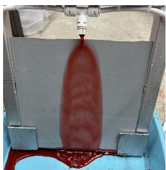
ค. การไหลของน้ำบนแผ่นผิวหยาบ 1.97
