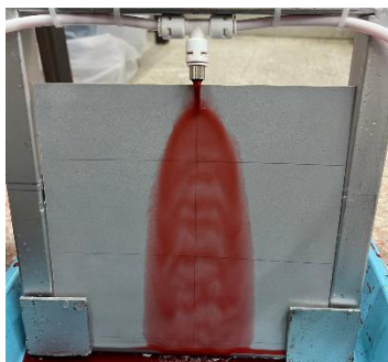
จ. การไหลของน้ำบนแผ่นผิวหยาบ 3.07
