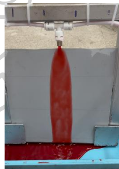
ข. การไหลของน้ำบนแผ่นผิวหยาบ 0.884
