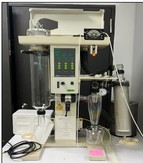
ภาพที่ 9 เครื่อง Spray dryer รุ่น Buchi B190 Mini Spray Dryer
