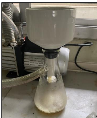
ภาพที่ 8 กรองสุญญากาศใช้กระดาษกรอง Whatman #1 ในกรวย Buchner
