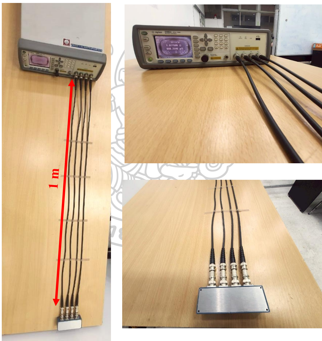
รูปที่ 4.1 ระบบการวัดค่าความต้านทานผ่านสายโคแอกเซียล RG-58/U แบบ 4-Wire
