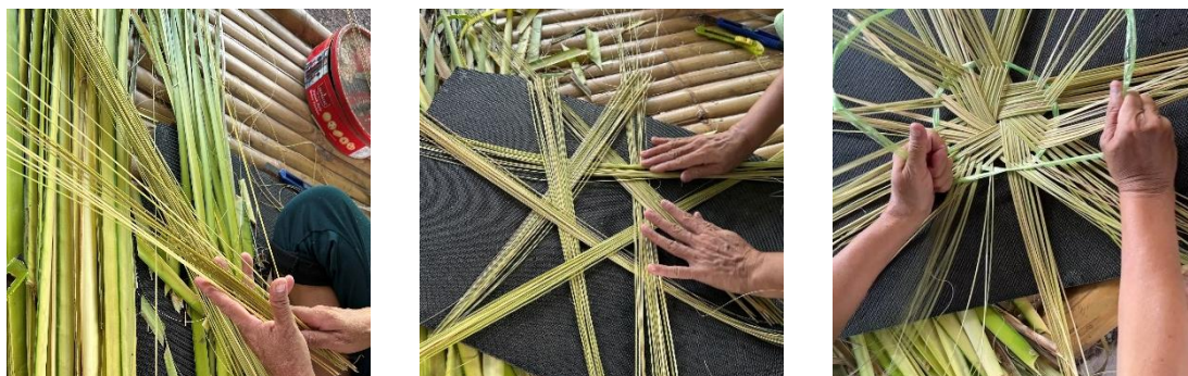
ภาพที่ 23 แสดงวิธีการขึ้นรูปงานจักสานก้านใบมะพร้าว (ที่มา : จิตรลดา เครือเทศ 2568)
