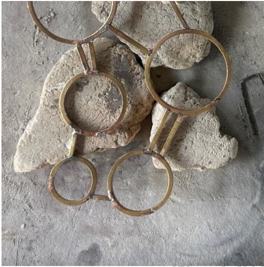
ภาพที่ 51 การประกอบตัวเรือนสร้อยคอ 1
