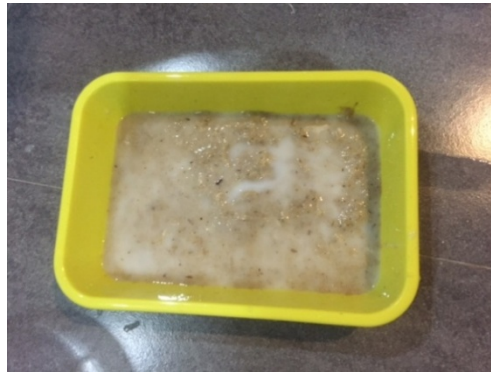
ภาพที่ 49 ภาพแสดงขั้นตอนการนำไยกล้วยผสมกับกาว 1
