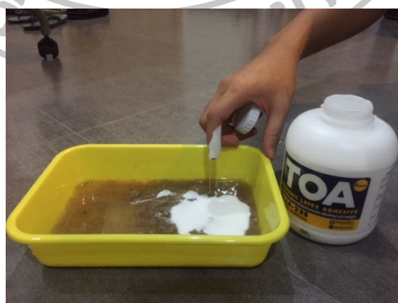
ภาพที่ 48 ภาพแสดงขั้นตอนการนำใยกล้วยผสมกับกาว 1
