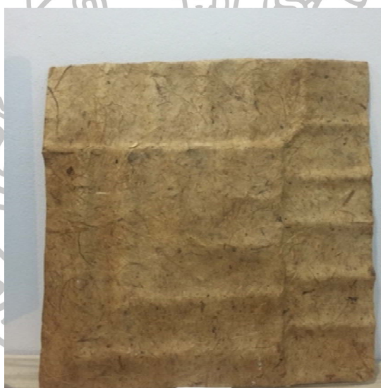
ภาพที่ 72 ภาพใยกล้วยที่แกะจากแม่พิมพ์
