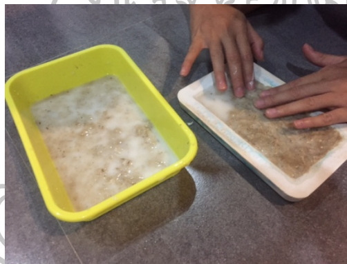
ภาพที่ 50 ภาพแสดงขั้นตอนการนำไยกล้วยผสมกับกาว 1
