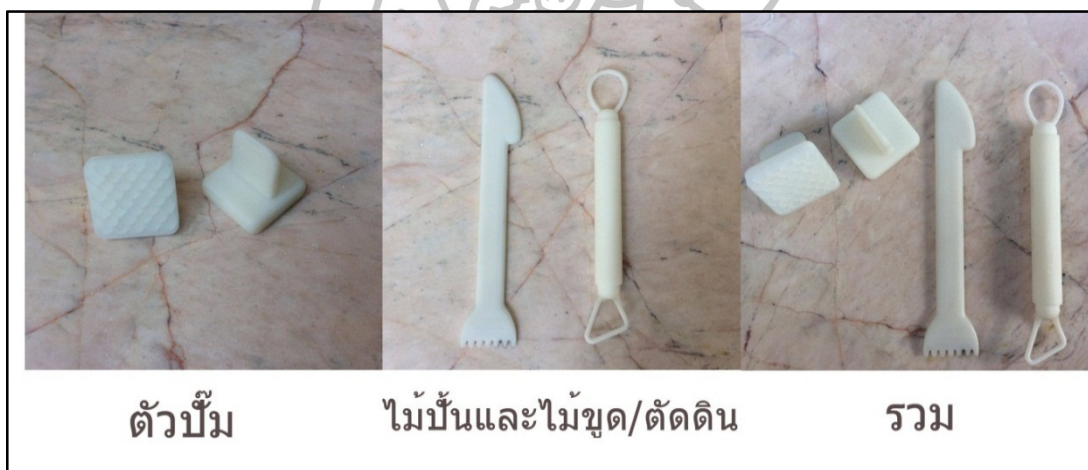
ภาพที่ 55 แสดงตัวปั๊มดินและอุปกรณ์เสริม
