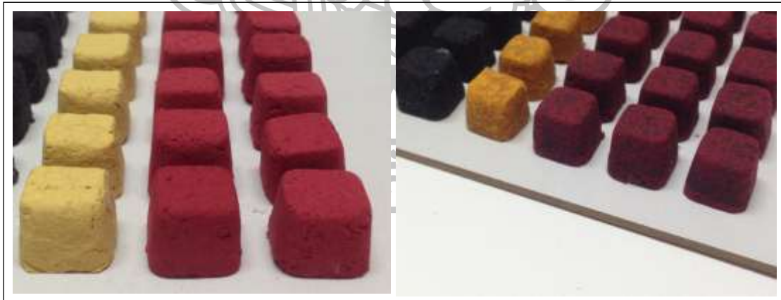
ภาพที่ 21 กระบวนการอัดเม็ดผสมน้ำยาอีพ็อกซี
