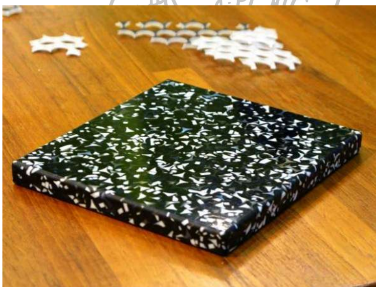
ภาพที่ 9 วัสดุใหม่จากเศษแก้วที่เหลือจากกระบวนการผลิต
