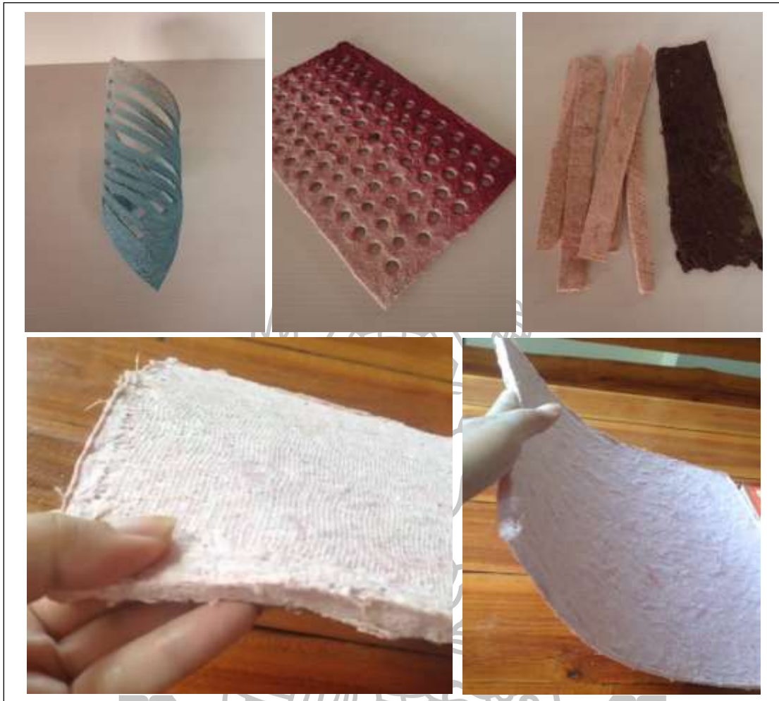
ภาพที่ 24 ทดลองคุณสมบัติของผ้าแบบแข็ง สามารถตัด เจาะ ตัดได้ โค้งงอได้เล็กน้อย
