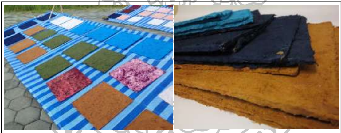
ภาพที่ 23 ผ้าที่อัดเรียงแบบแผ่นแข็งไม่ผสมวัสดุอื่น
