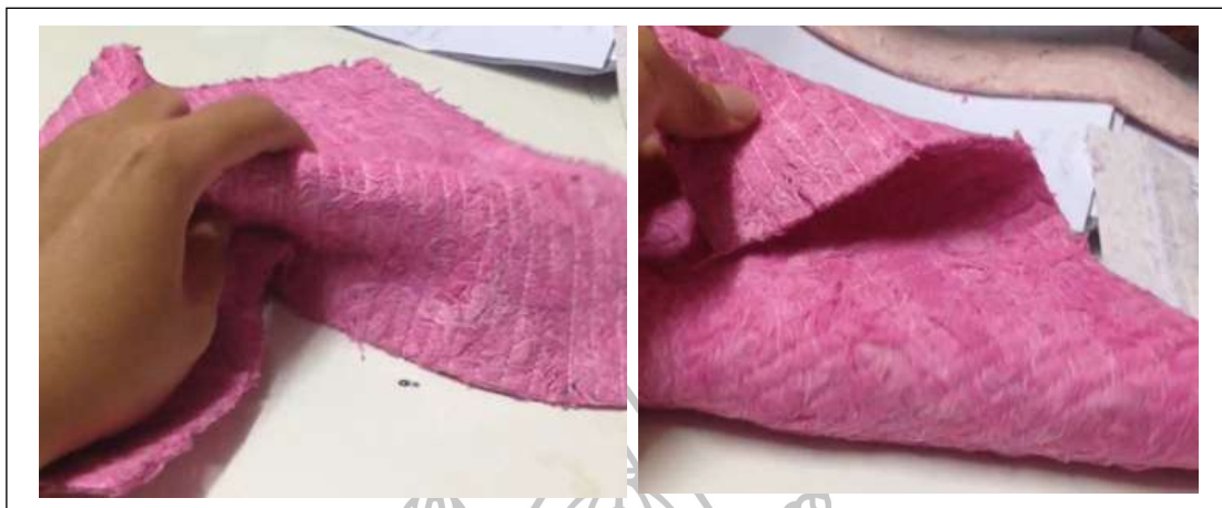
ภาพที่ 26 วัสดุเศษผ้าฝ้ายที่ผ่านกระบวนการอัดม้วน
