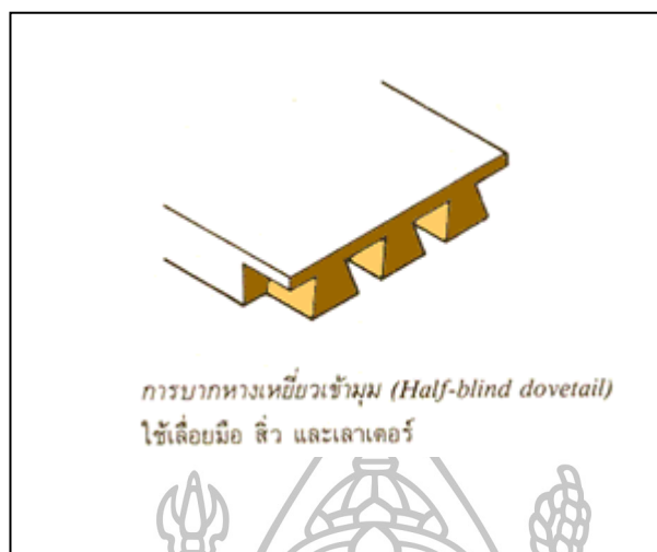
ภาพที่ 63 การบากหางเหยี่ยวเข้ามุม (Half-blind dovetail) ที่มา: Furniture design, การออกแบบเฟอร์นิเจอร์ - ชนิดของข้อต่อ - ข้อต่อร่องและเดือย, เข้าถึงเมื่อ 1 มิถุนายน 2558, เข้าถึงได้จาก http://furniture-designs.flcf.com.br/th/furniture-designs-176.html
