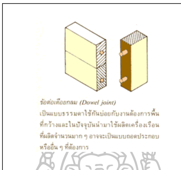
ภาพที่ 67 ข้อต่อเดือยกลม (Dowel joint)
