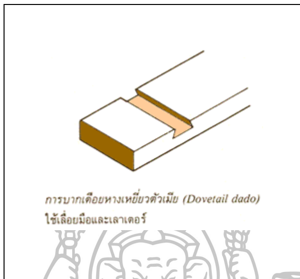
ภาพที่ 61 การบากเคียวหางเหยี่ยวตัวเมีย (Dovetail dado)
