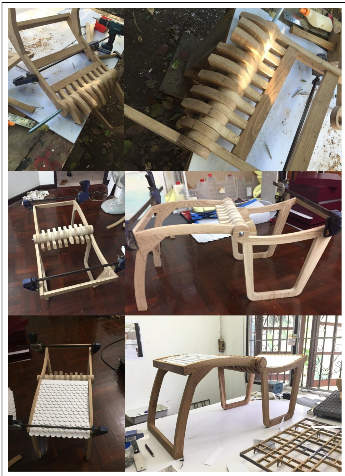
ภาพที่ 100 การประกอบโครงสร้างรวม
