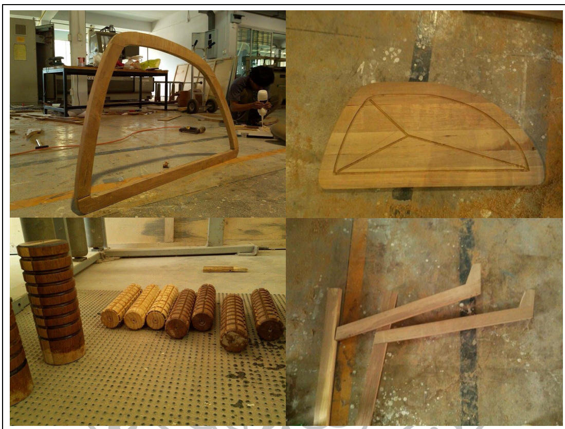
ภาพที่ 110 การตัดไม้เพื่อเตรียมประกอบชิ้นงาน (ภาพถ่ายโดย ปณิธิอารีสง่ากุล, 20 พฤษภาคม 2558)
