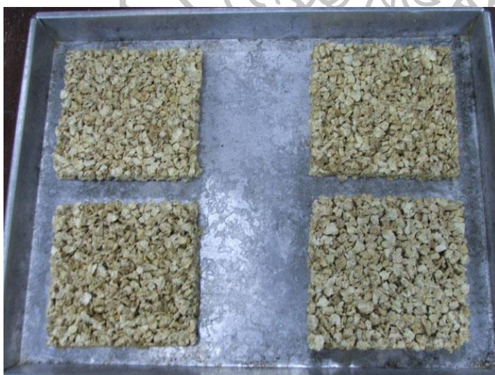
ภาพที่ 30 แผ่นฉนวนที่ขึ้นรูปด้วยสัดส่วนน้ำยางต่อน้ำทั้ง 4 สัดส่วน
