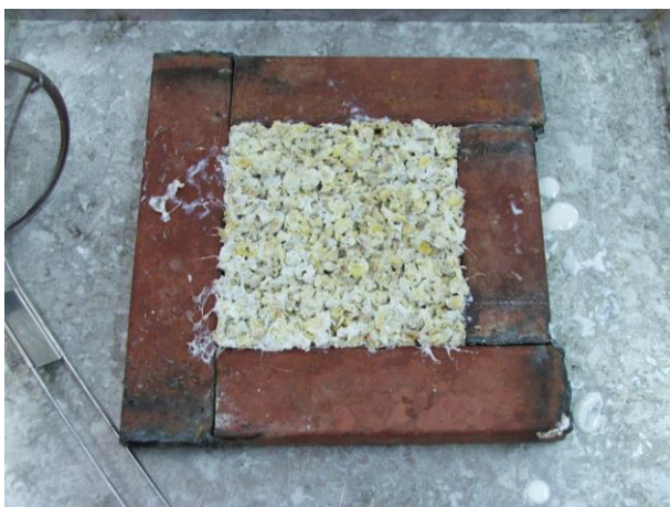
ภาพที่ 27 ใส่ซังข้าวโพดที่ผ่านการจุ่มน้ำยางลงในแม่พิมพ์
