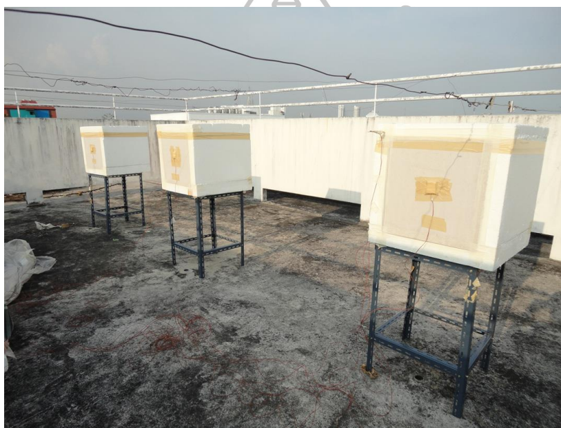
ภาพที่ 39 การทดสอบความสามารถในการป้องกันความร้อนด้วยกล่องทดลอง
