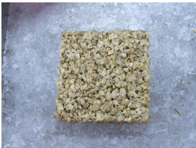
ภาพที่ 29 แผ่นฉนวนหลังอบเสร็จแล้ว
