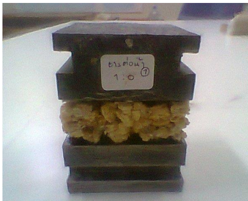
ภาพที่ 33 แสดงการจับยึดชิ้นทดสอบเพื่อหาค่าแรงดึงตั้งฉากกับผิวหน้า
