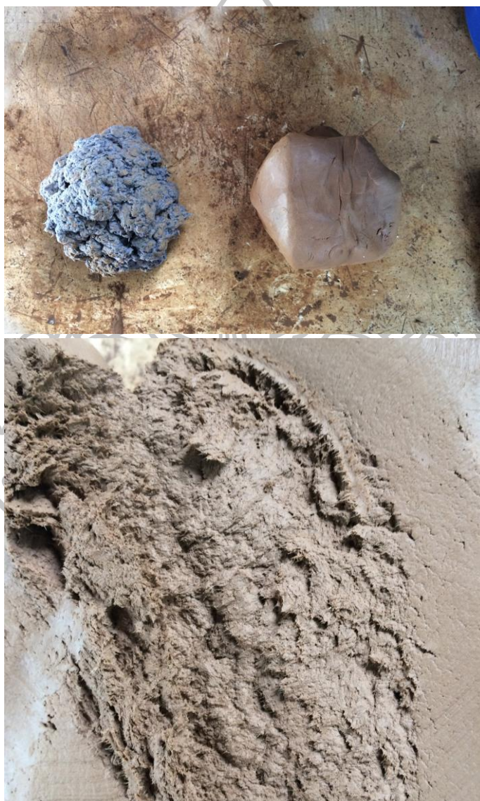
ภาพที่ 21 แสดงตัวอย่างดินที่ผสมกับเยื่อกระดาษรีไซเคิล
