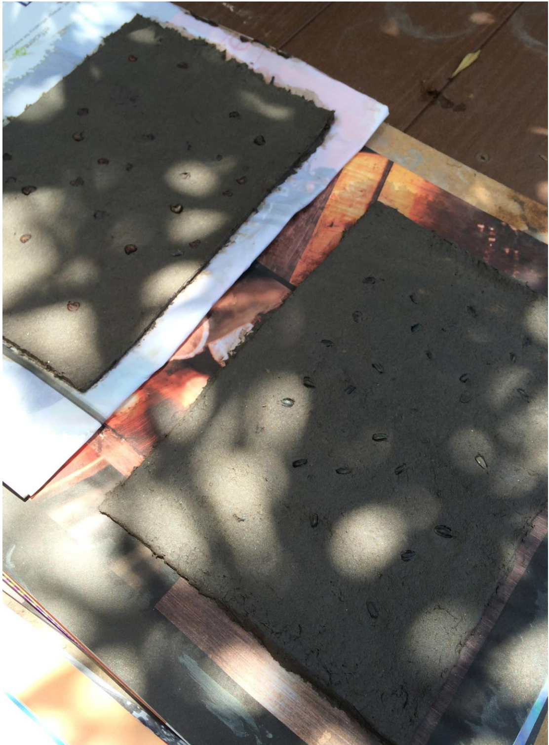
ภาพที่ 43 แสดงตัวอย่างการตากดินผสมกระดาชรีไซเคิล และเม็ดดพั้นรุ้เพื่อให้แห้ง
