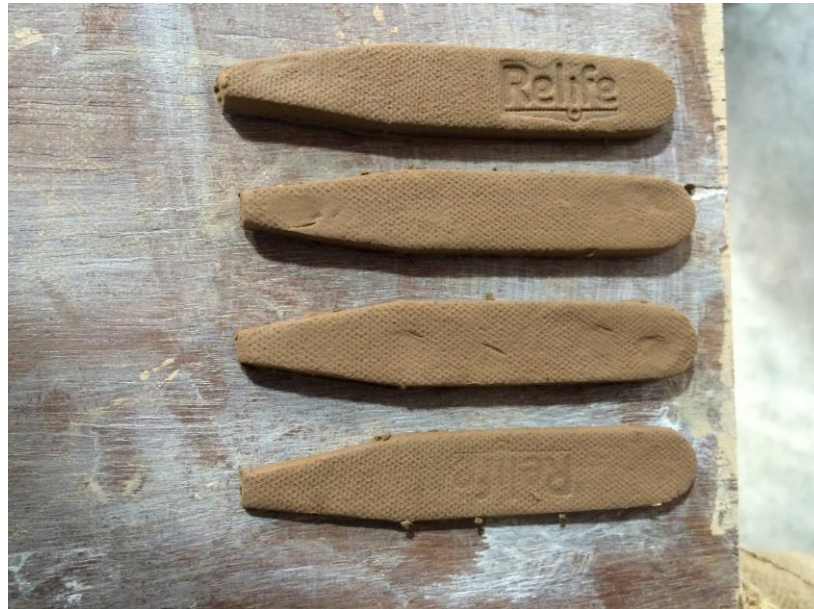
ภาพที่ 22 แสดงตัวอย่างการขึ้นรูปแบบแผ่น และกดแม่พิมพ์เป็นรูปทรง
