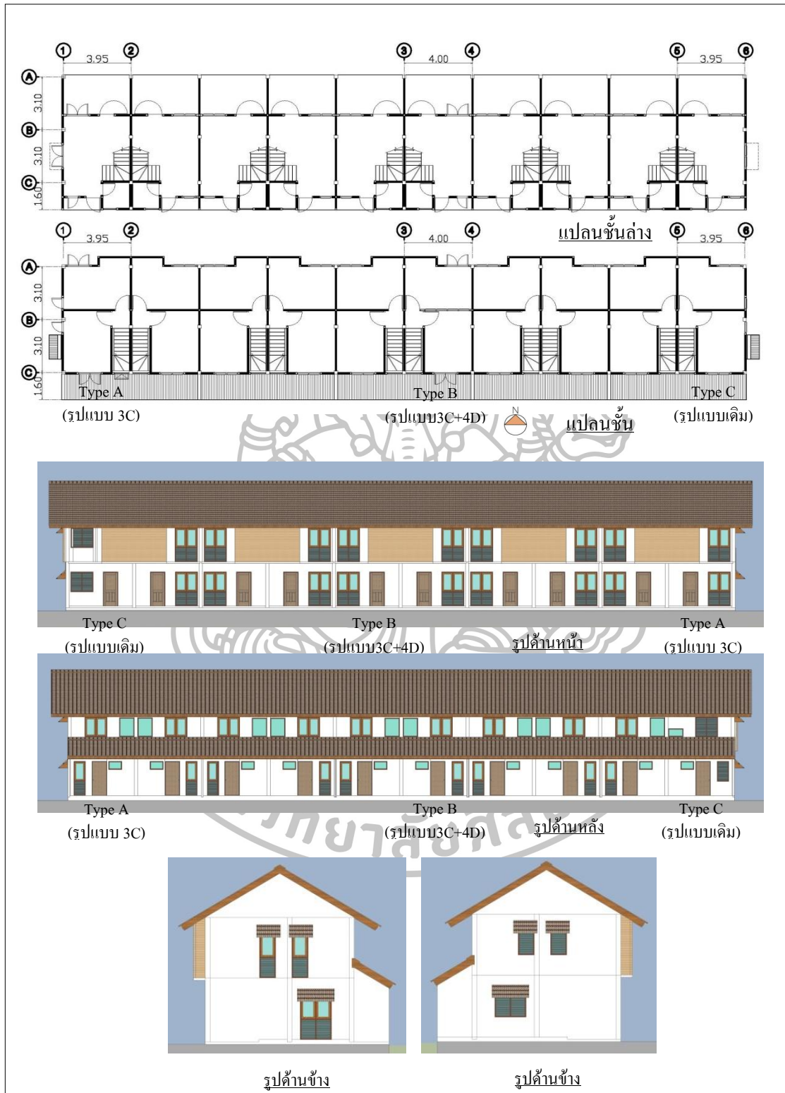
ภาพที่ 73 แสดงแปลนและรูปด้านกรณีศึกษารูปแบบช่องเปิดที่มีคะแนนรวมสูง ลำดับที่ 1 (ทางเลือก 2) (TypeA = รูปแบบ 3C, TypeB = 3C+4D, TypeC = รูปแบบเดิม)
