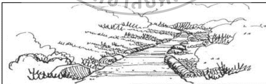
ภาพที่ 10 การป้องกันผลกระทบต่อสภาพแวดล้อมบริเวณขอบเส้นทางแบบ 1 ใช้ก่อนอิฐกำหนดเป็น แนวทาง
