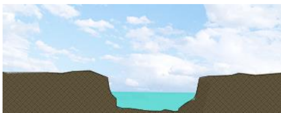
ภาพที่ 16 แสดงภาพตัด ลำคลองทั่วไปที่มีความชัน
