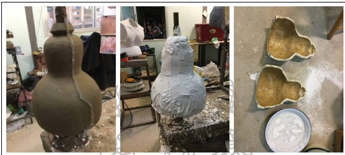
ภาพที่ 74 ภาพแสดงขั้นตอนการทำพิมพ์มังกู ผลงานที่ 1
