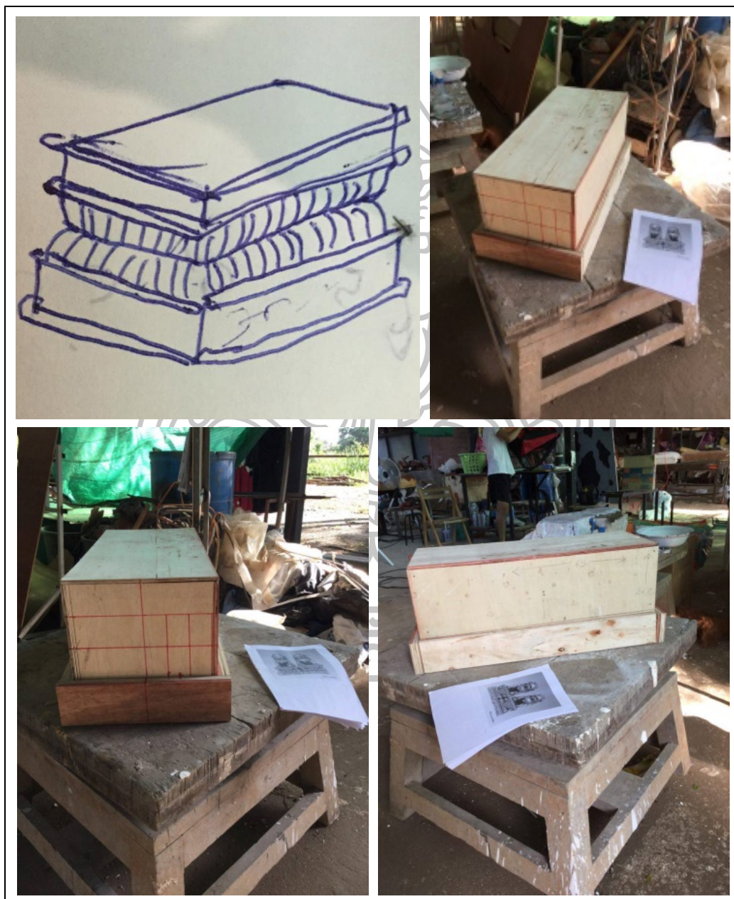
ภาพที่ 108 ภาพแสดงขั้นตอนประกอบไม้อัดเพื่อเป็นโครงสร้างฐานบัว ผลงานชิ้นที่ 2
