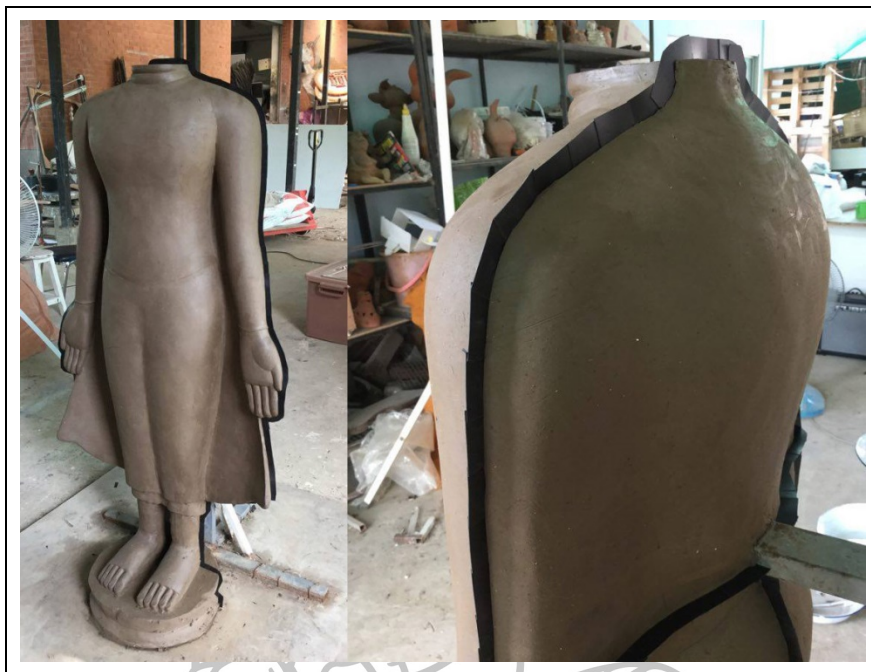
ภาพที่ 133 ภาพแสดงขั้นตอนการแบ่งแม่พิมพ์ผลงานชิ้นที่ 3
