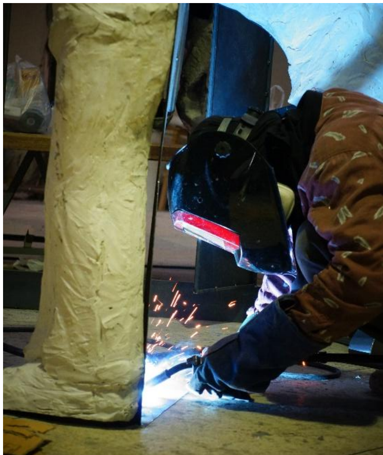
ภาพที่ 38 ขั้นตอนเชื่อมเหล็กและประกอบชิ้นส่วนของผลงานวิทยานิพนธ์ ชั้นที่ 2
