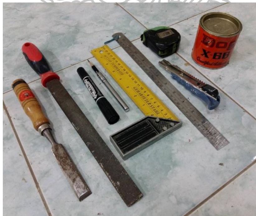
ภาพที่ 24 สิว ตะไบ ปากกา ไม้บรรทัดมุมฉาก ไม้บรรทัด มีดคัตเตอร์ ตลับเมตร และกาวยาง
