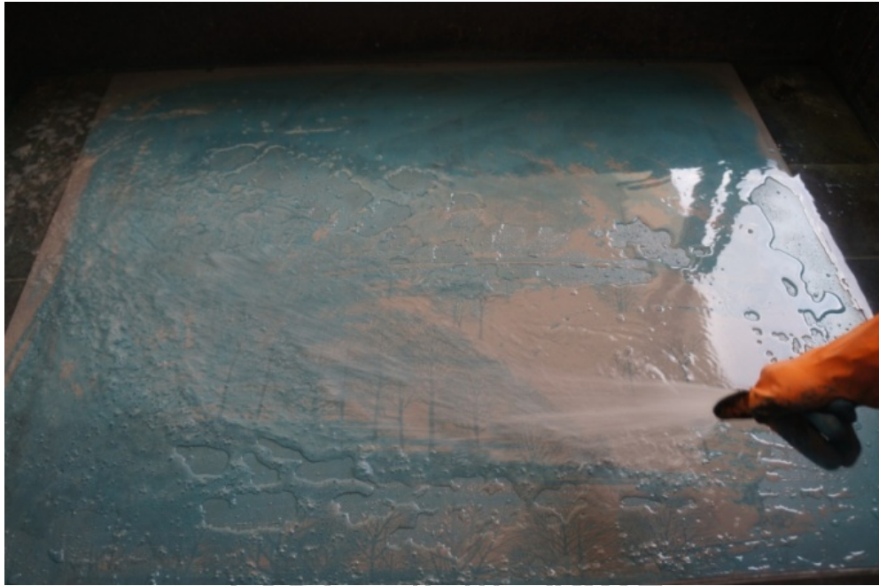
ภาพที่ 40 แสดงกระบวนการล้างแม่พิมพ์ด้วยน้ำเพื่อนำไปสู่กระบวนการพิมพ์
