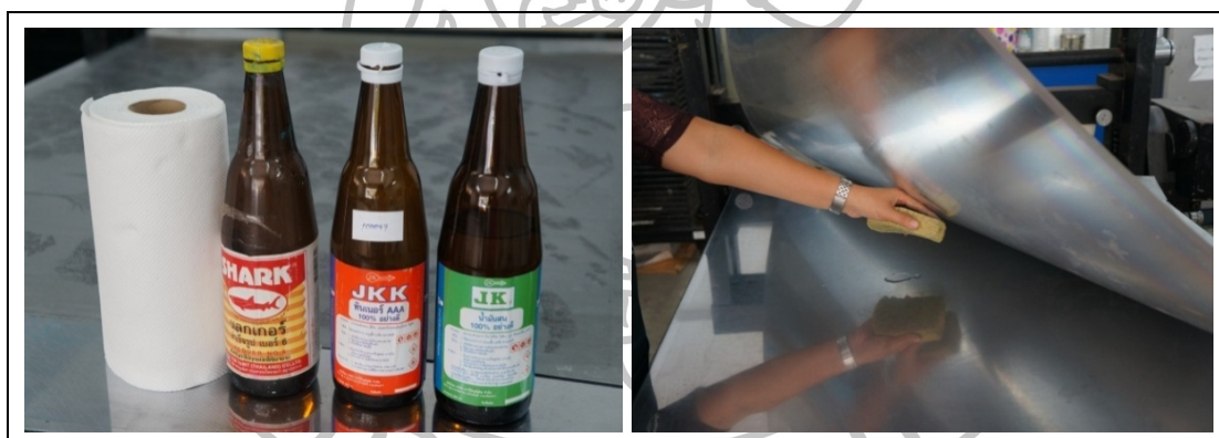
ภาพที่ 37 แสดงวัสดุอุปกรณ์ใช้ในการล้างแม่พิมพ์และการเตรียมแม่พิมพ์
