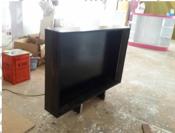
ภาพที่ 45 การประกอบตู้ไฟแต่ด้านให้เข้ากัน
