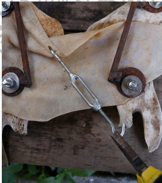
ภาพที่ 40 แสดงการดึงหนังวัวด้วยตัวดึงลวดสลิง
