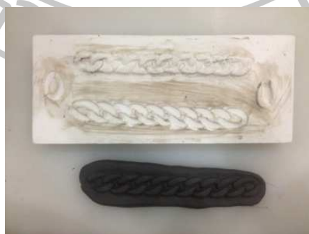
ภาพที่ 51 การอัดดินลงบนแม่พิมพ์ และโซ่ที่ได้สำหรับการทดลอง
