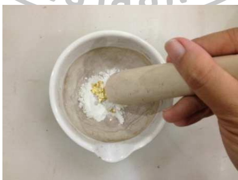
ภาพที่ 46 การบดแผ่นทองคำเปลวกับดินเบนโทไนท์
