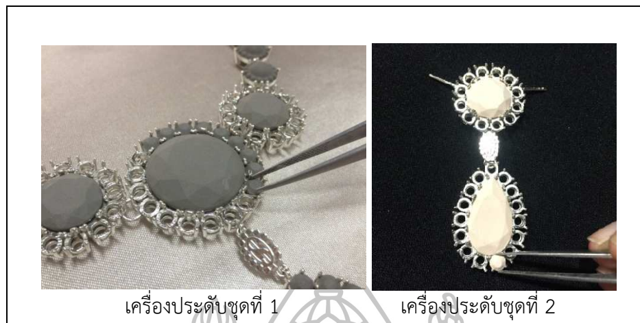
ภาพที่ 93 การฝังอัญมณีดินลงบนตัวเรือนโลหะ
