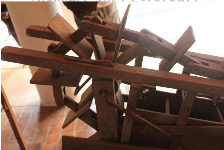
ภาพที่ 8 ภาพแสดงลักษณะของการเข้าไม้(เครื่องวิดน้ำ)
