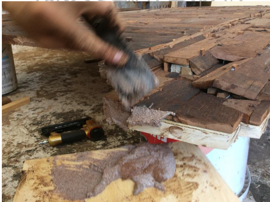
ภาพที่ 24 ภาพแสดงลักษณะการโป้วซีเล็กน้อยผสมกาวลาเท็กซ์เพื่อเก็บรอยละเอียด
