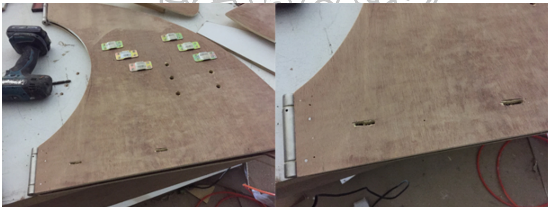
ภาพที่ 65 แสดงเจาะรูเพื่อเป็นที่เก็บแผ่นรองรับแขน (ภาพโดย นภดล สิทธิวงษ์ ผู้วิจัย)
