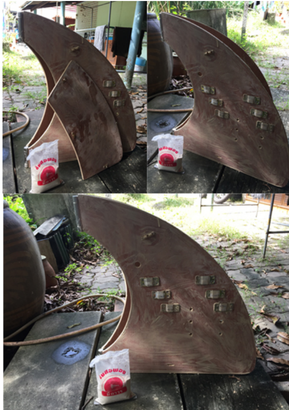
ภาพที่ 66 แสดงขั้นตอนการลงดินสอพองเพื่ออุดเสี้ยนไม้ (ภาพโดย นภดล สิทธิวงษ์ ผู้วิจัย)
