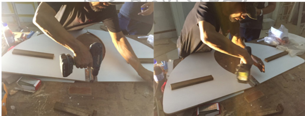
ภาพที่ 62 แสดงการติดบานพับบนชิ้นงานต้นแบบ (ภาพโดย นภดล สิทธิวงษ์ ผู้วิจัย)
