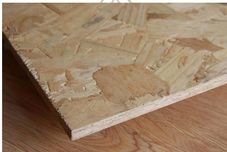
ภาพที่ 22 แสดงไม้อัด OSB (Oriented Strand Board Wood)
