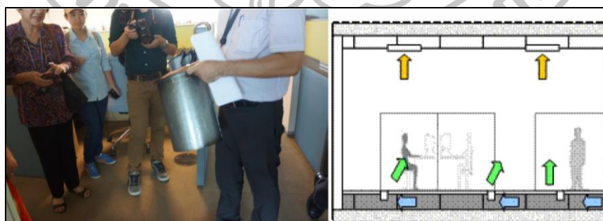
ภาพที่ 18 แสดงท่อปรับอากาศจากพื้นอาคาร ZEB at BCA Academy (ถ่ายโดยผู้วิจัย ณ อาคาร ZEB at BCA Academy เมื่อพฤษภาคม 2558)
