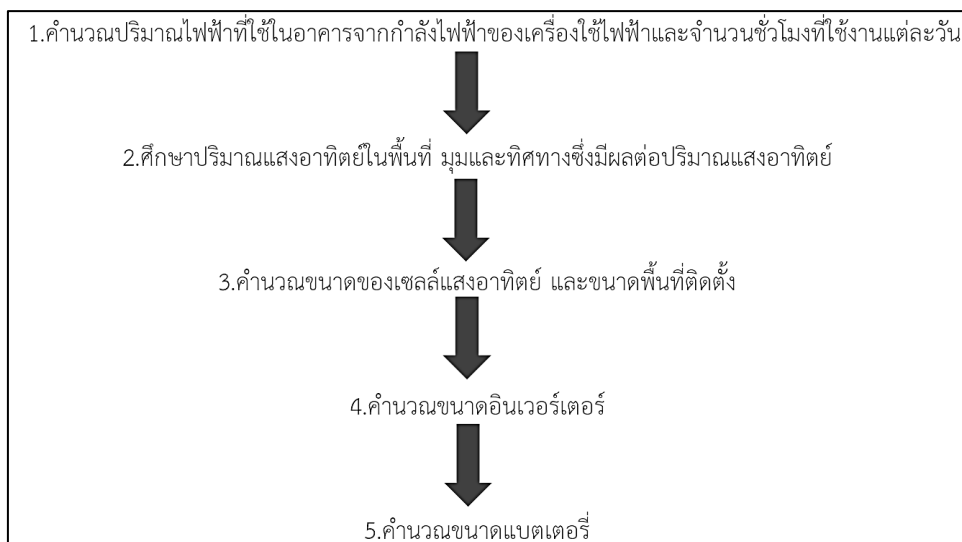
ภาพที่ 32 แสดงขั้นตอนการออกแบบขนาดระบบเซลล์แสงอาทิตย์
