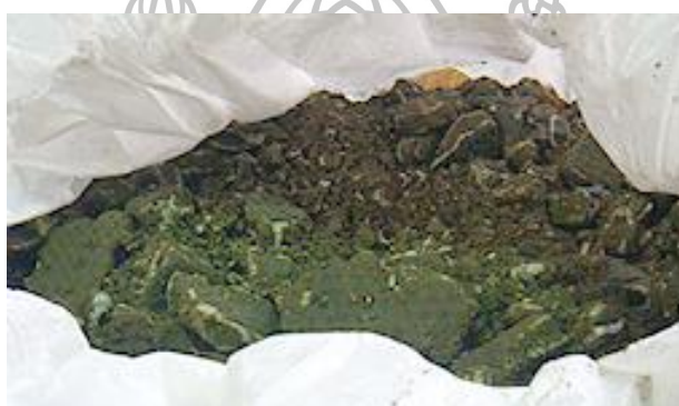
รูปที่ 2.4 กากตะกอนที่มีการปนเปื้อนโลหะทองแดง
