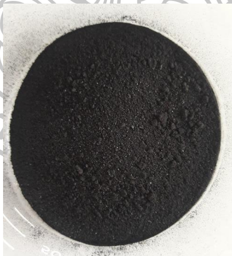
รูปที่ 4.3 ตัวดูดซับแทนนินที่สังเคราะห์จากไบโกระถิน
